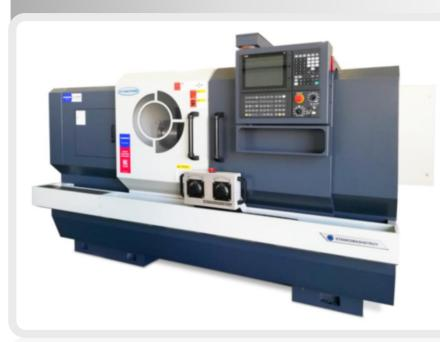
Станок предназначен для черновой и чистовой токарной обработки заготовок типа валов прямолинейным и криволинейным профилем и других заготовок разнообразной конфигурации.
