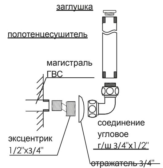
\*Заглушки входят в комплектацию полотенцесушителя и уже установлены производителем на заводе. Во избежание протечек заглушек не рекомендуется выкручивать и менять их при установке. Заглушка с воздухоотводчиком (кран Маевского) и заглушка располагаются в верхней части полотенцесушителя.
