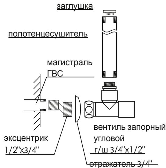
**Схема 1.2 Подключение уголками**
