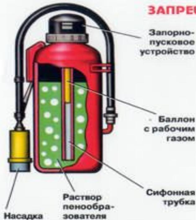
**ПРИНЦИП ДЕЙСТВИЯ.** Раствор пенообразователя вытесняется избыточным давлением рабочего газа (воздух, азот,  $\text{CO}_2$ ). При срабатывании запорно-пускового устройства прокалывается заглушка баллона с газом, и раствор выдавливается через каналы и сифонную трубку. В насадке он перемешивается с засасываемым воздухом, образуя пену, которая охлаждает горящее вещество и изолирует его от кислорода
