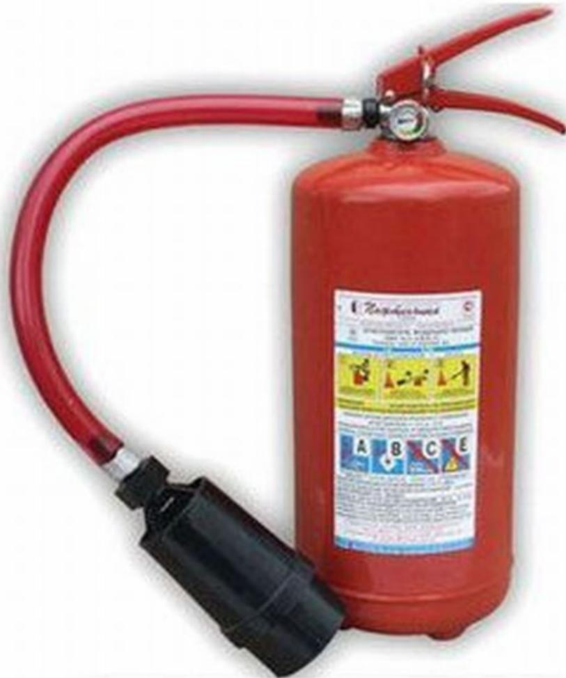
Принцип действия основывается на использовании огнетушащей пены, образованной за счет пенообразователя, водного раствора и вытесняющего газа из баллона высокого давления в головке огнетушителя. Такая пена, практически полностью состоит из воздуха (доля содержащегося в пене воздуха доходит до 90%), также в ней содержится небольшой процент пенообразующего вещества - 0,2 % и воды (9.8%). Пенообразователь смешивается с водой, под действием рабочего газа, исключительно в момент применения.
