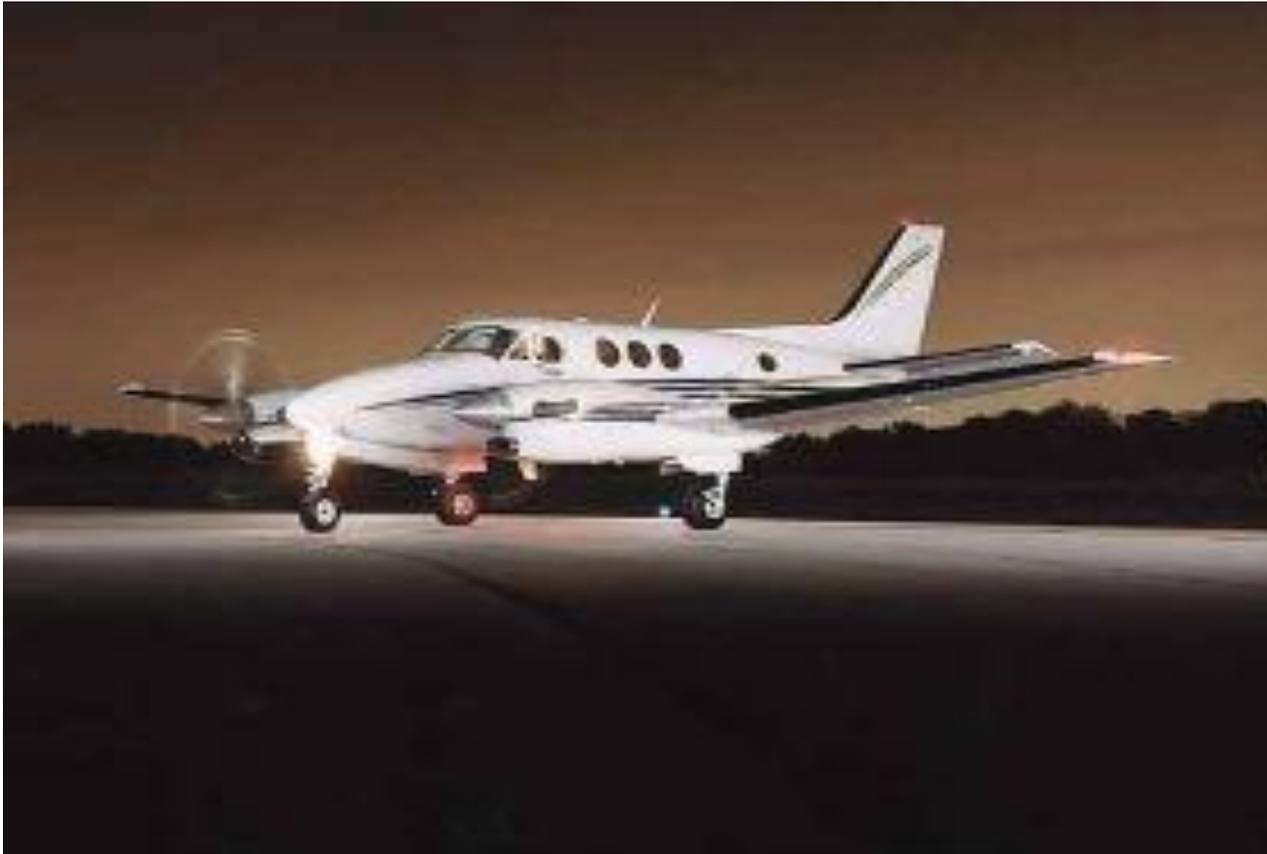
Для проведения цифровой аэрофотосъемки используется двухмоторный самолет «King Air C90A», оборудованный широкоформатной цифровой аэрокамерой «VEXCEL UltraCamX». Камера синхронизирована с бортовой и трассовыми системами GPS. Для географической привязки снимков в плане и по высоте проводится планово-высотное обеспечение, используя пункты государственной геодезической сети.
