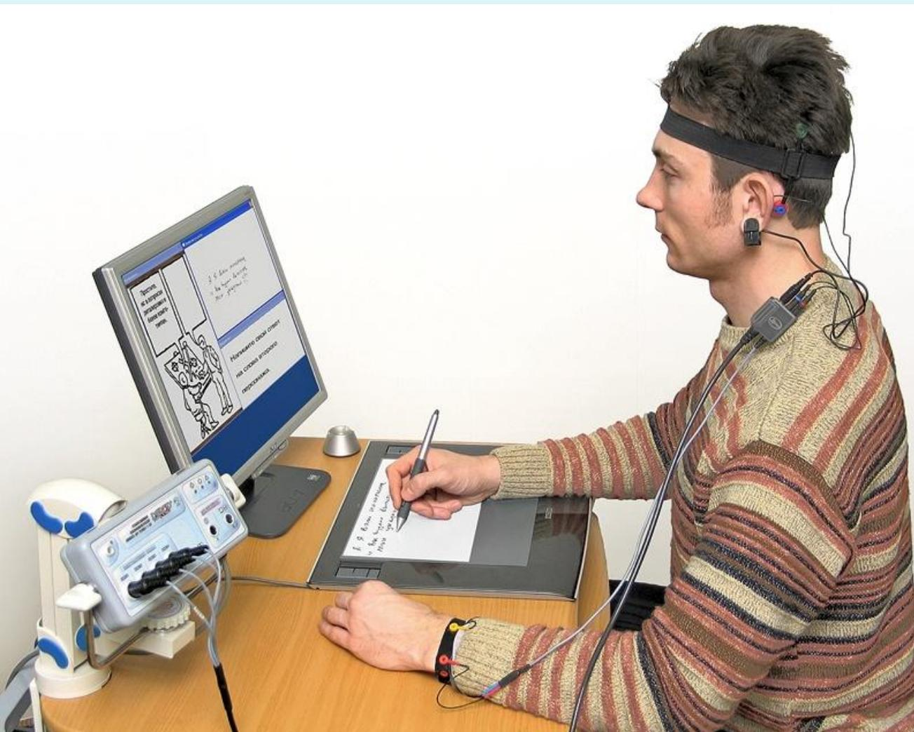
Специальная укладка с датчиками и электродами позволяет одновременно регистрировать сигналы кожно-гальванической реакции (КГР), фотоплетизмограммы (ФПГ), электрокардиограммы (ЭКГ) и электроэнцефалограммы (ЭЭГ)
