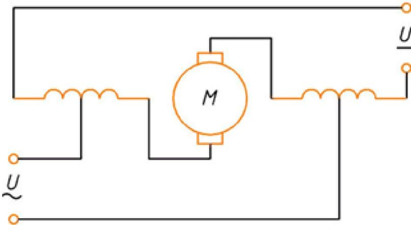
В качестве универсального используют **двигатель последовательного возбуждения.**
