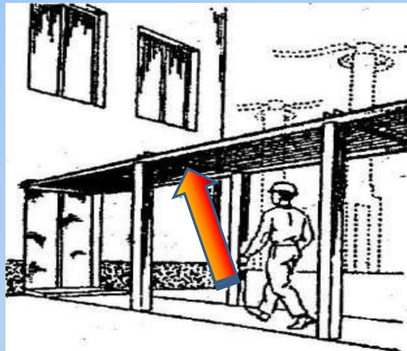
Рис. 2. Экранирующий навес над проходом в здание
