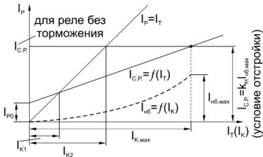
Рис. 5.11. Зависимость  $I_P = f(I_T)$ .
