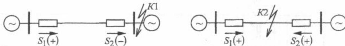
Рис. 79. Направление мощности  $S$  при различных к.з.
