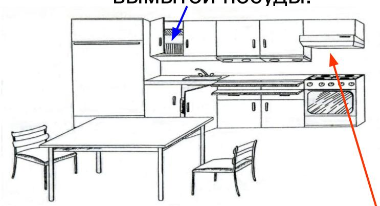
Над плитой устанавливают вытяжное устройство, такой аппарат очищает воздух от жира, сажи и пыли и частично устраняет запахи.
