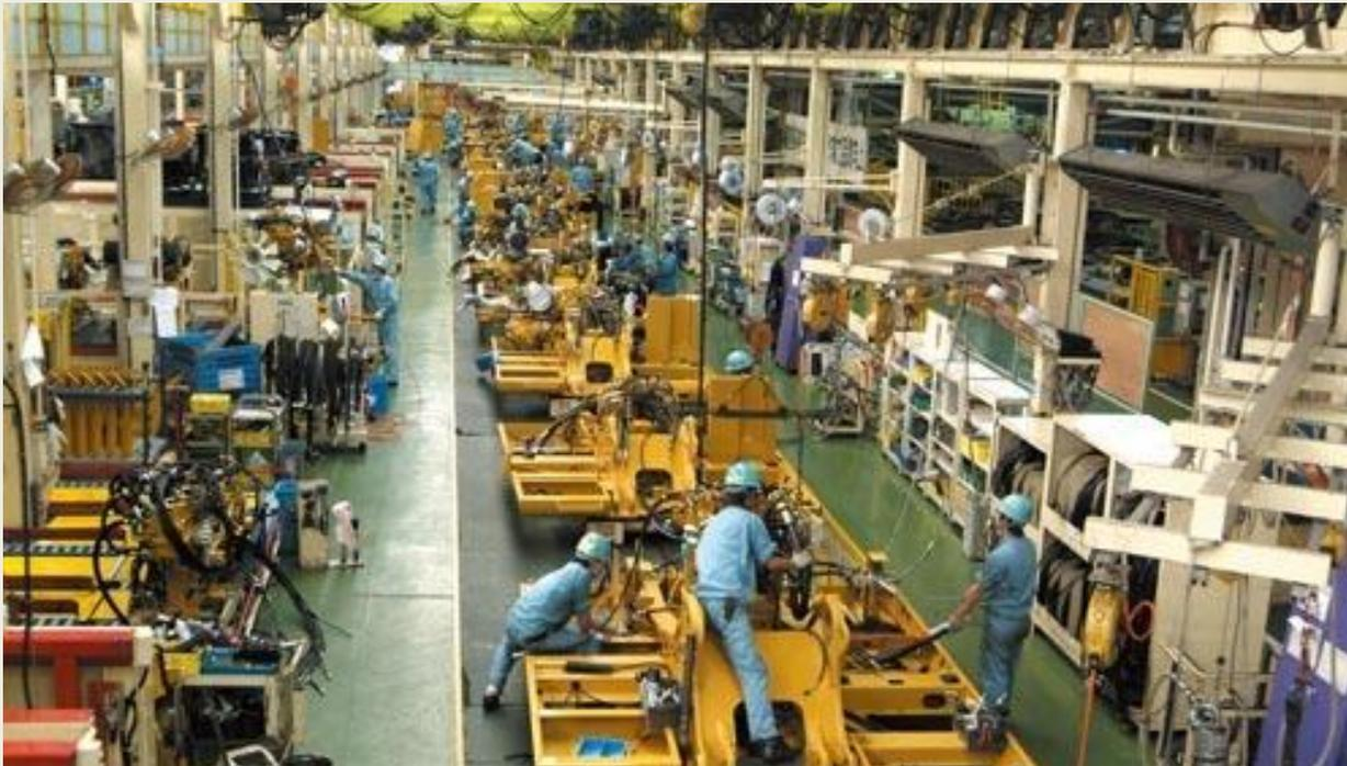
Если по требованию технологического процесса **операции должны выполняться при неподвижном объекте**, применяют **конвейеры с пульсирующим движением**. В этом случае привод конвейера автоматически включается только на время, необходимое для перемещения изделий на следующую операцию.
