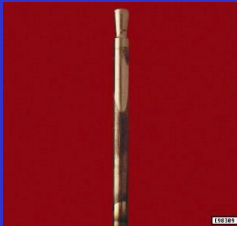
Износ хромового покрытия
