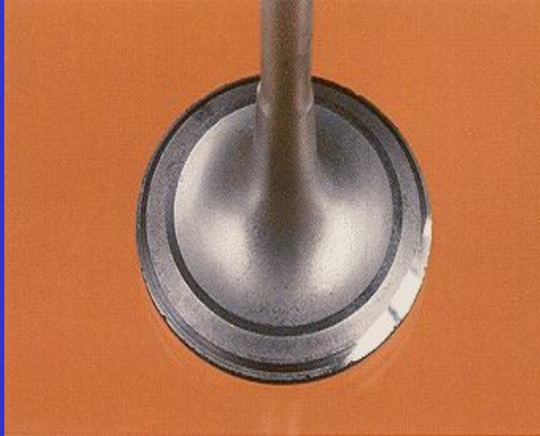
Признаки деформации стержня
