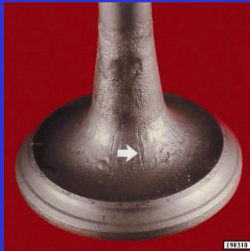
трещины у галтели
