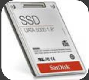
Твердотельный накопитель (англ. SSD, Solid State Drive, Solid State Disk) — энергонезависимое, перезаписываемое компьютерное запоминающее устройство без движущихся механических частей. Следует различать твердотельные накопители, основанные на использовании энергозависимой (RAM SSD) и энергонезависимой (NAND или Flash SSD) памяти.
