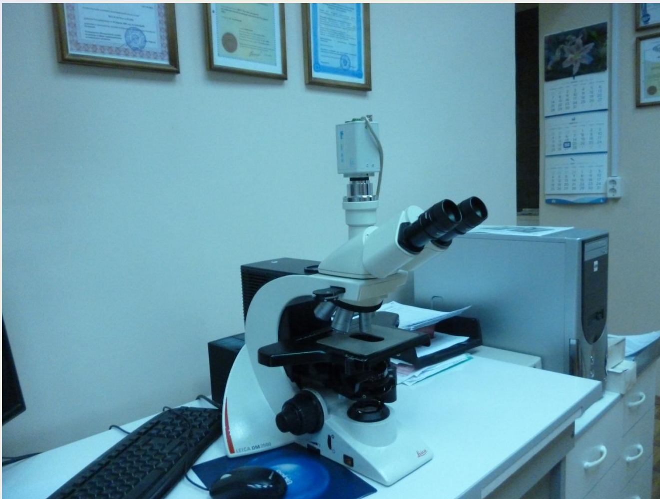
Поляризационный микроскоп DM2500 фирмы Leica с видеокамерой и передачей изображения на экран монитора
