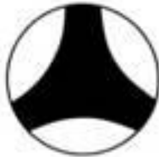
Рис. 396. Поперечное сечение рабочей части профайла.
