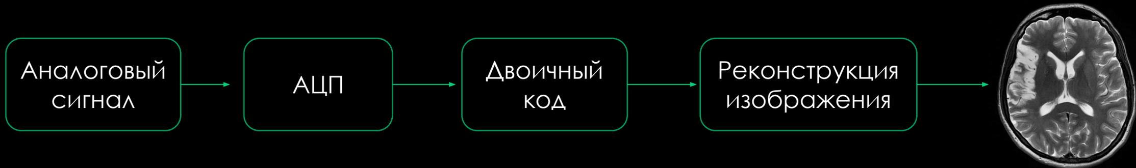
1/3 стоимости КТ – сканера хранит цифровой сигнал в течение сканирования и реконструирует изображения после его окончания. Матрица изображения – 512x512 КТ-чисел
