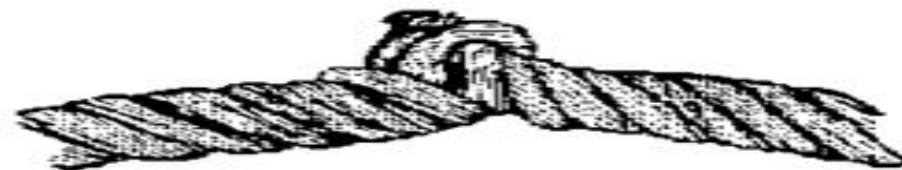
ж) перекручивание каната
