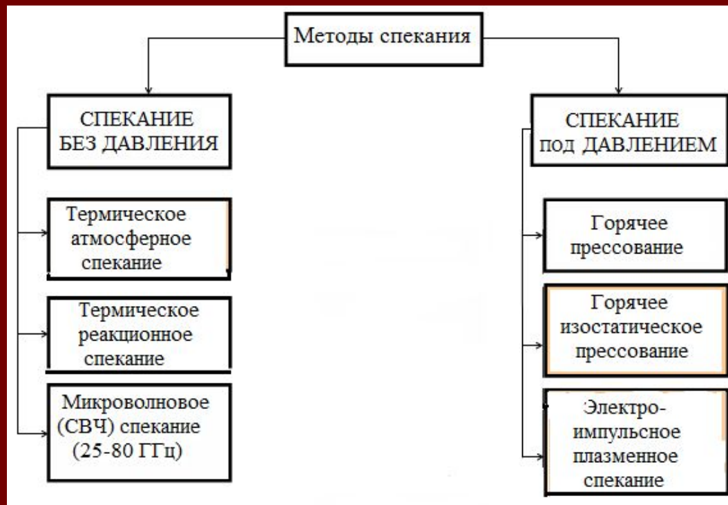
Рис. 1. Классификация методов спекания смесей нанопорошков
