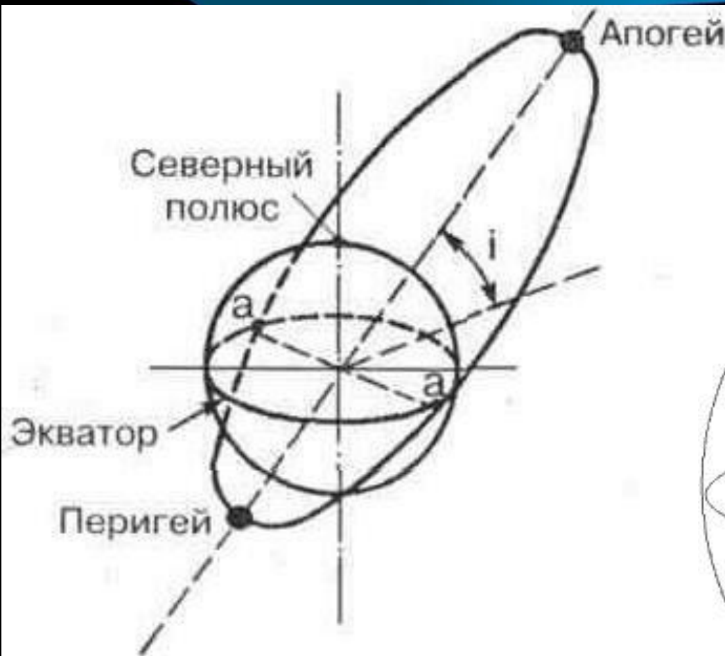
Рис. 3.1. Наклонная эллиптическая орбита ИСЗ
