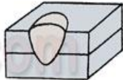
прорезной сварной шов
