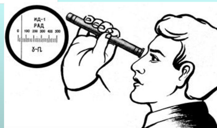
Рис. 1.75. Визначення величини дози гамма-нейтронного випромінювання
