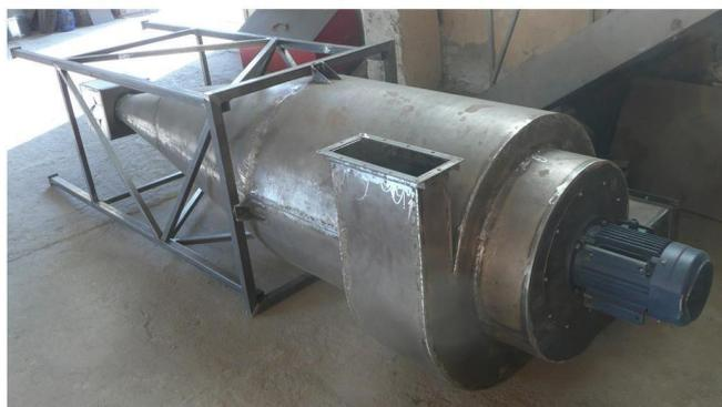
Циклон ЦВ со встроенным вентилятором - для древесных и зерновых отходов
