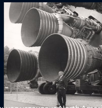
Двигательная установка North American Rockwell, Rocketdyne F1, 5 двигателей установлены на 1-ой ступени космического носителя Сатурн-5 рядом с конструктором ракеты Вернером фон Брауном. РД 180
