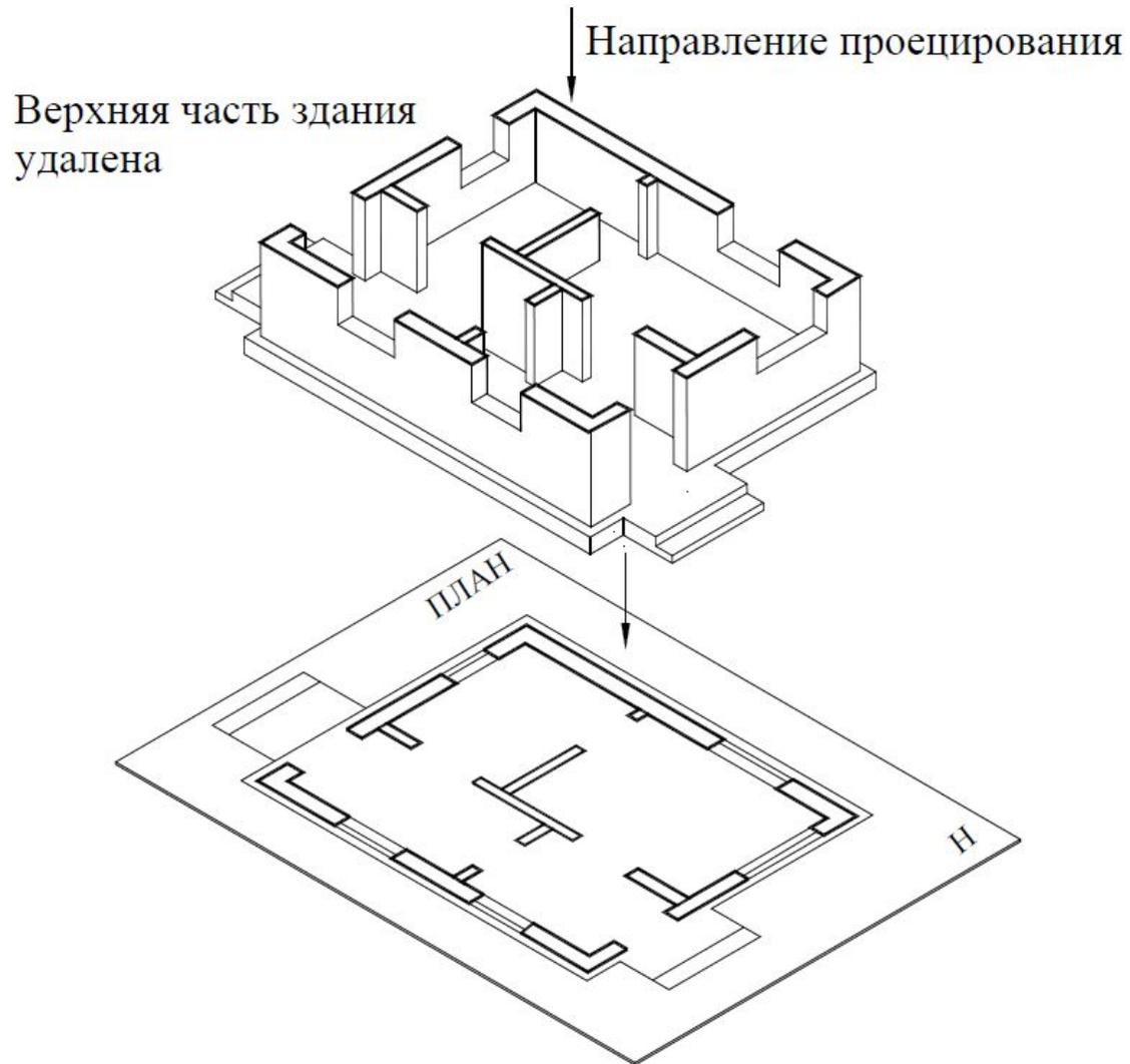
*План этажа дает представление о конфигурации и размерах здания, выявляет форму и расположение отдельных помещений, оконных и дверных проемов, простенков, капитальных стен, колонн, лестниц, перегородок.*
