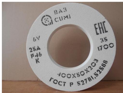
Шлифовальные круги на особо прочных связках (до 50 м/сек.) дополнительно маркируются на торце круга.
