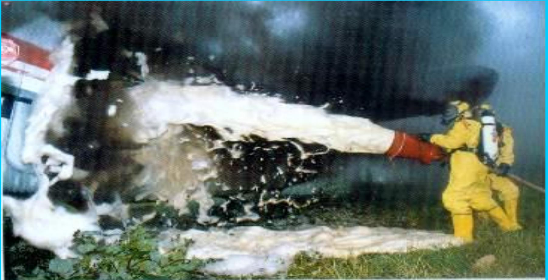
ТУШЕНИЕ ПОЖАРОВ ДВИГАТЕЛЕЙ ОСУЩЕСТВЛЯЮТ ручными стволами, подающими огнетушащее средство непосредственно в очаг пожара через специальные люки или возможные прогары капотов.
