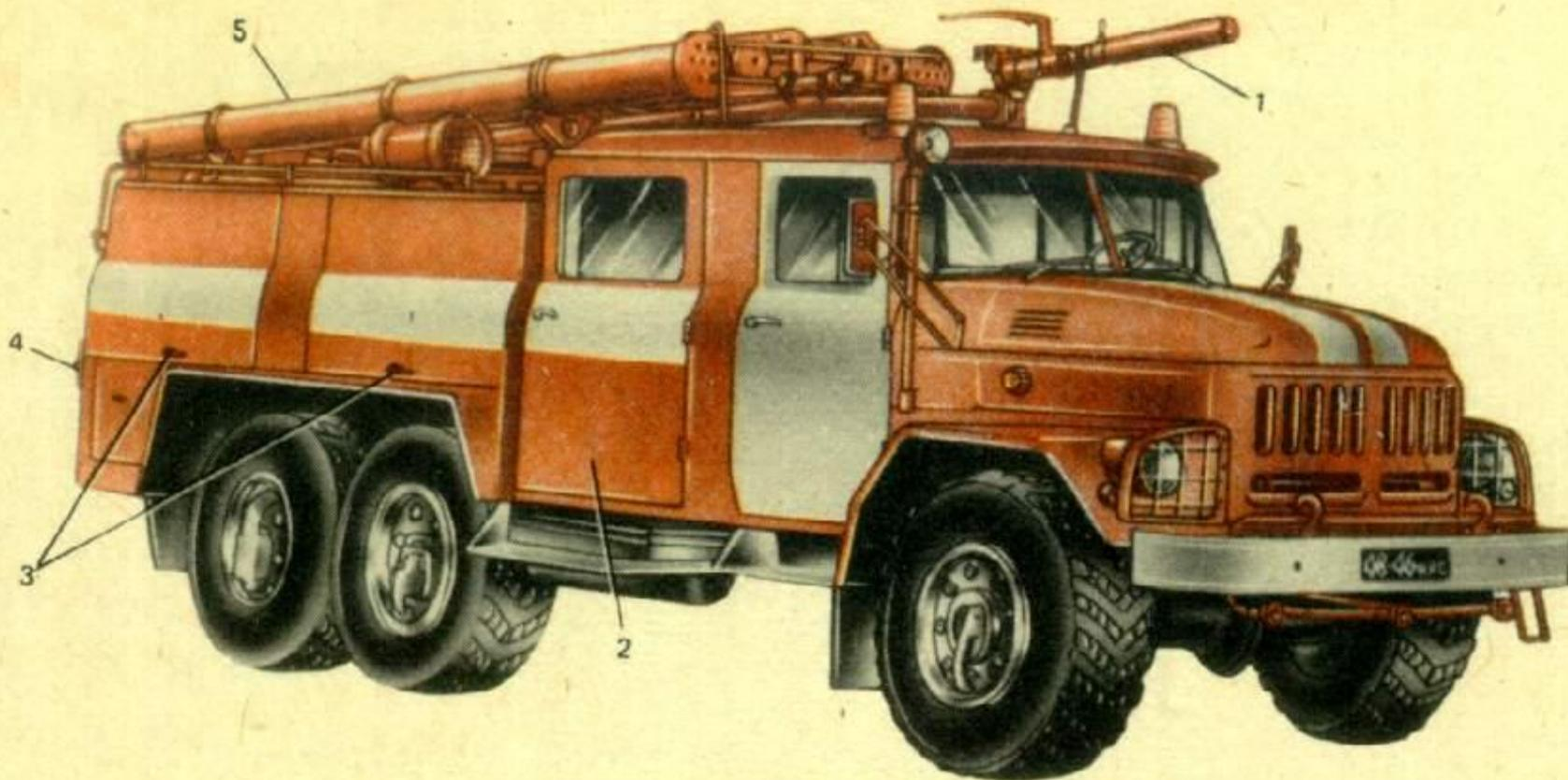
*1 - лафетный ствол; 2 - кабина боевого расчета; 3 - отсеки для оборудования; 4 - насосный отсек; 5 - пенал для всасывающего рукава.*
