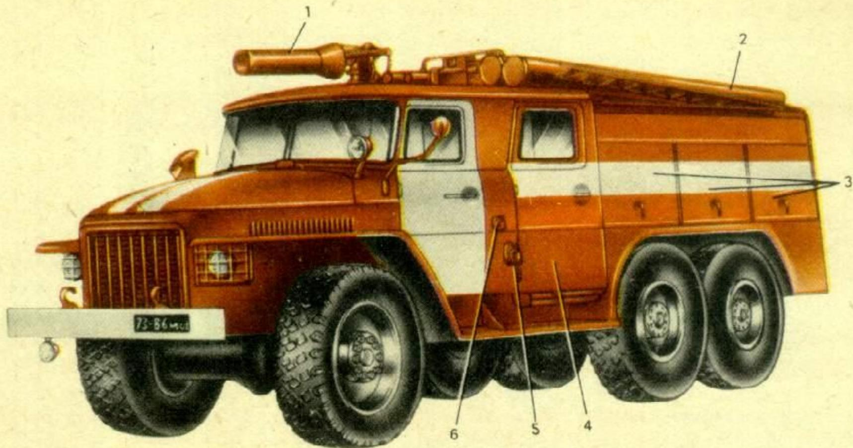
*1 - лафетный ствол; 2 - пенал для всасывающего рукава; 3 - боковые отсеки для размещения оборудования; 4 - кабина боевого расчета; 5 - всасывающий патрубок насоса; 6 - напорный патрубок насоса.*
