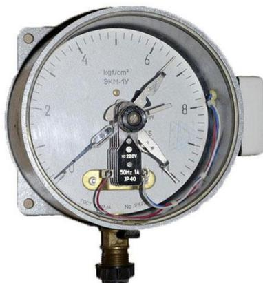
Электроконтактная группа прибора имеет механическое соединение со стрелкой показывающего элемента. При превышении величины порогового значения осуществляется замыкание или размыкание цепи. Оборудование можно настроить на срабатывание по понижению или повышению давления
