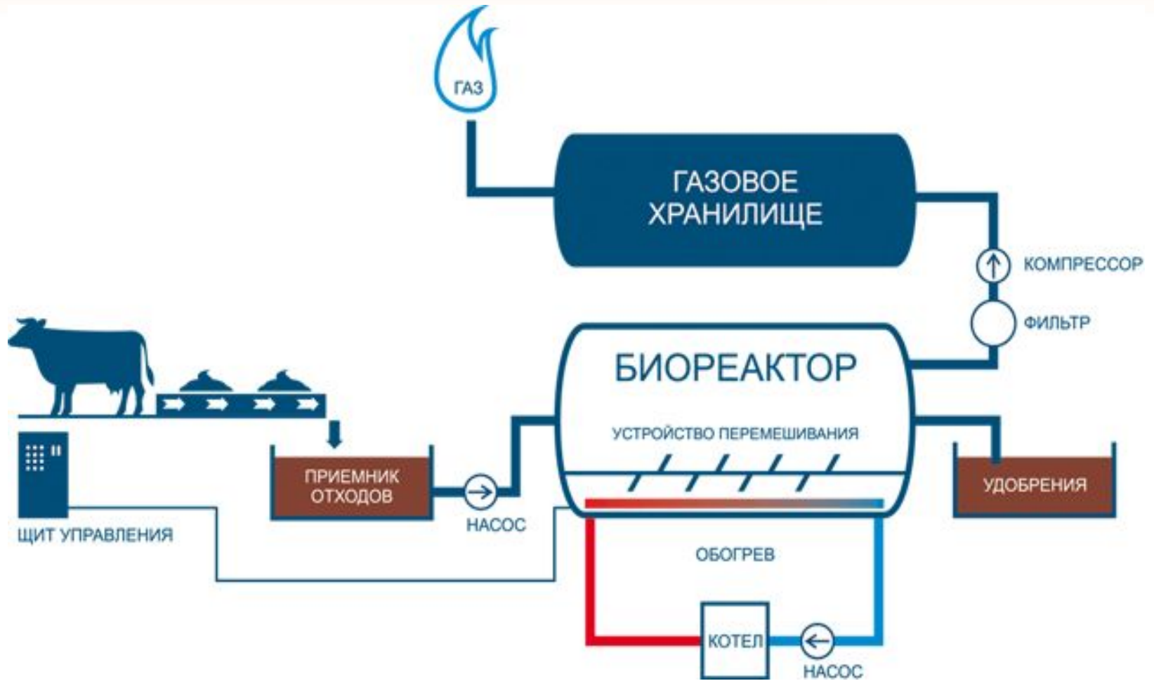
Рис.2 Схема процесса получения биогаза из отходов животноводства
