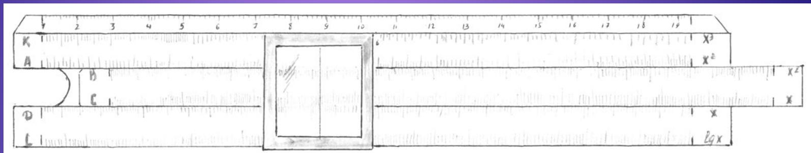
Логарифмическая линейка (счетная линейка) – инструмент, служащий для выполнения разнообразных действий (умножений, делений, извлечения корня, возведение в степень, тригонометрические вычисления, решение уравнения)
