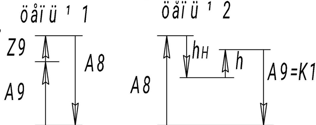
В цепи №2 известны заданная конструктором **глубина термоупрочненного слоя  $h = 1 \pm 0,2$**  и операционный размер  $A9 = K1 = 20_{-0,021}$ . **Из цепи №1 нашли операционный размер  $A8 = 20,2 - 0,03$**
