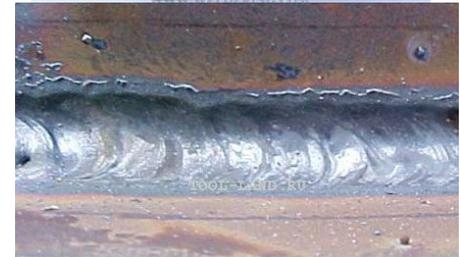
Группа 5 – нарушение формы шва: подрез, наплав, смещение, натек, прожог и др.
