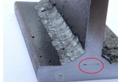
Группа 4 – несплавление и непровар – между металлом шва и основным металлом, между сварочными валиками, в корне шва.
