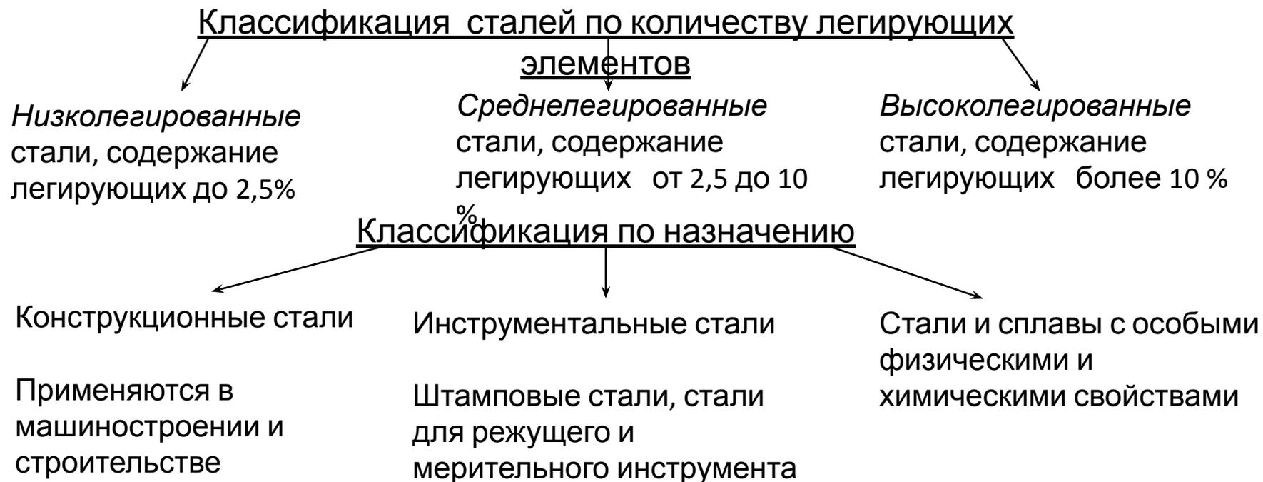
Стали и сплавы с особыми физическими и химическими свойствами:
