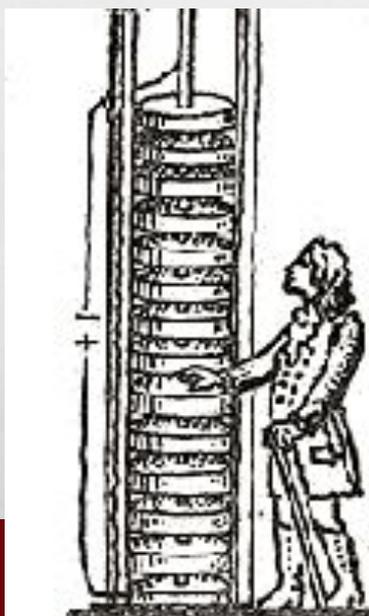
Его первый источник тока — «вольтов столб» был построен в точном соответствии с его теорией «металлического» электричества. Вольт положил друг на друга попеременно несколько десятков небольших цинковых и серебряных кружочков, проложив меж ними бумагу, смоченную подсоленной водой.
