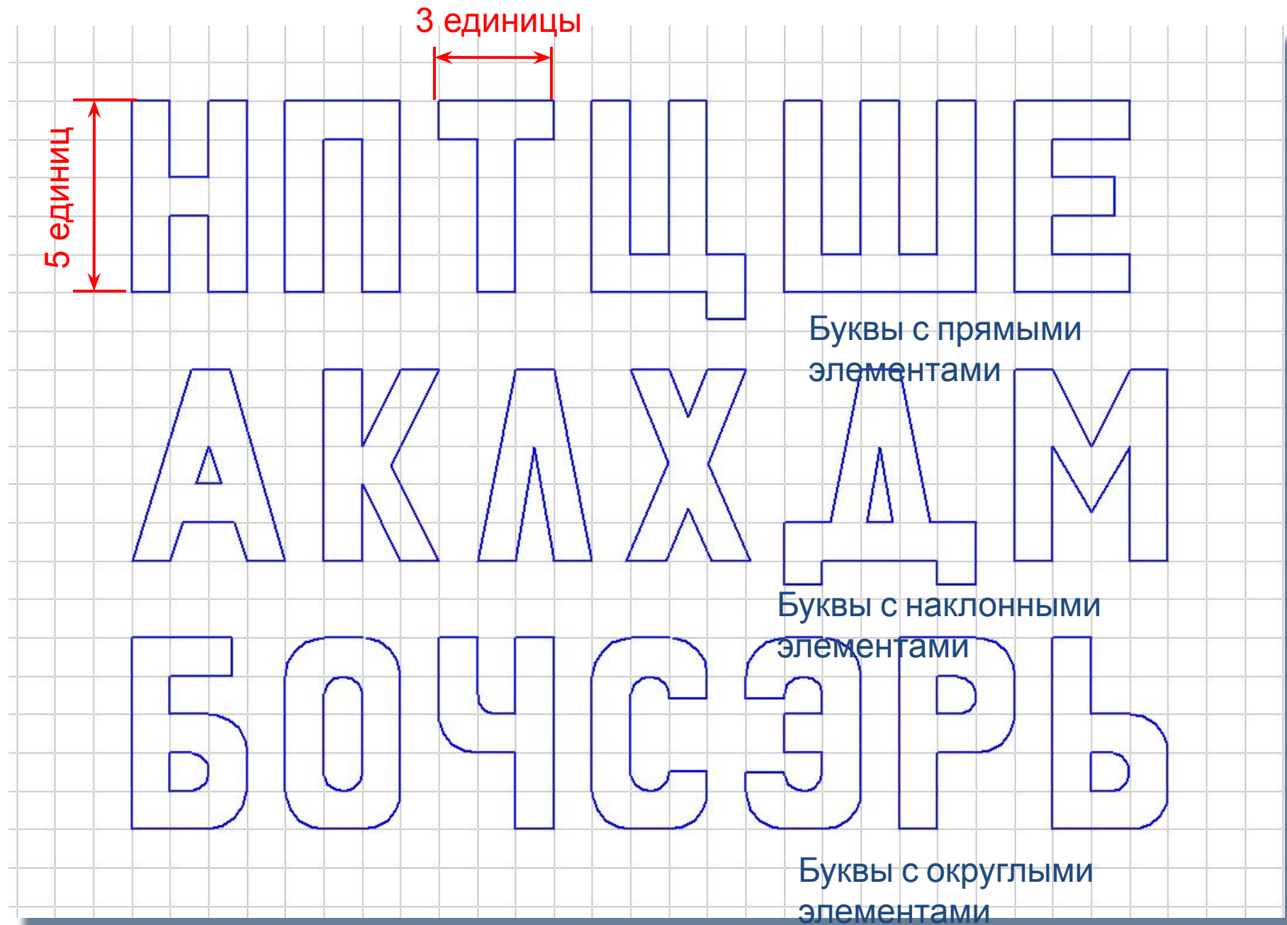
Рубленый шрифт. Построение букв по сетке (лист в клетку). Пропорции букв
