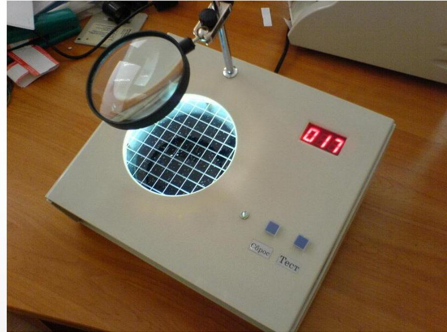
**Прибор для счета колоний** - полуавтоматический счетчик, снабженный иглой с пружинным устройством. Легкий нажим иглы на участке дна чашки Петри, соответствующей положению колонии, оставляет на стекле метку. При этом держатель поднимается вверх, цепь замыкается и показания счетчика увеличиваются на единицу.
