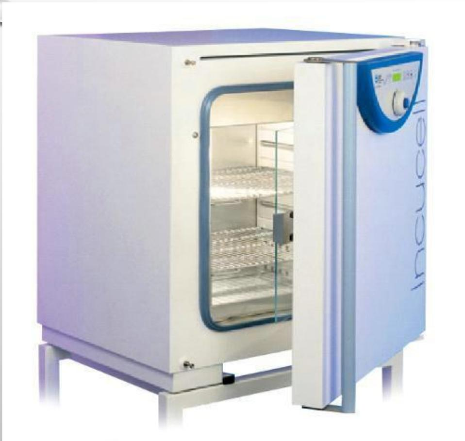
**Термостат** - аппарат, в котором поддерживается постоянная температура. Оптимальная температура для размножения многих микроорганизмов  $37^{\circ}\text{C}$ . Термостаты бывают суховоздушными и водяными. Используются для
