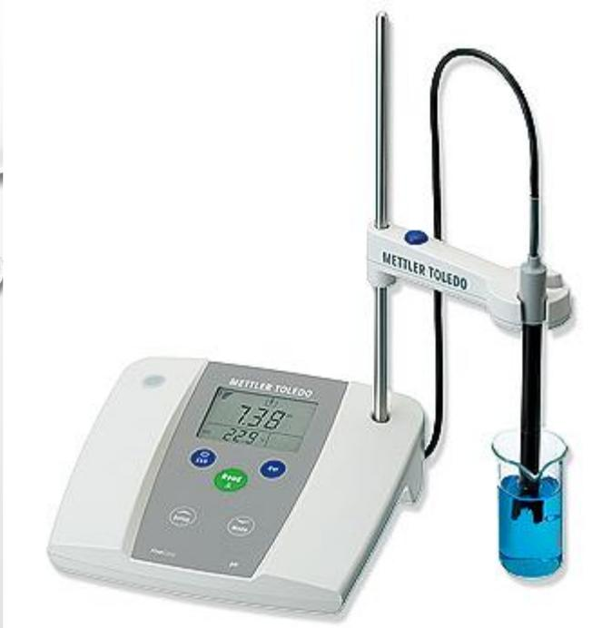
**pH-метр** — прибор для измерения водородного показателя (показателя рН), характеризующего активность ионов водорода в растворах, воде, пищевой продукции и сырье, объектах окружающей среды и производственных системах непрерывного контроля технологических процессов, в том числе в агрессивных средах.
