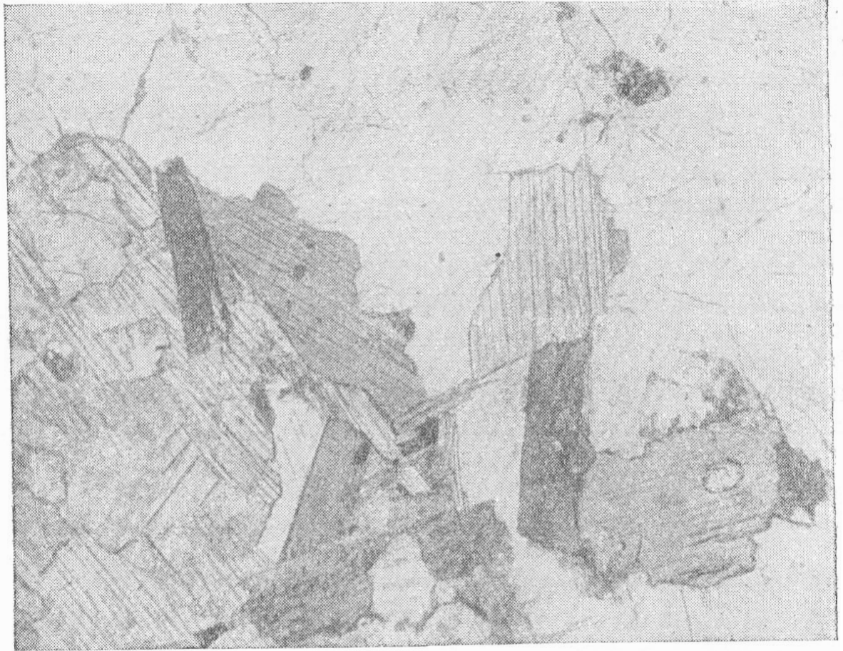
Рис. 10. Сростки биотита и мусковита в двуслюдяном граните мас- сива Пиа-Биок. Увеличение 45, николи параллельны.
