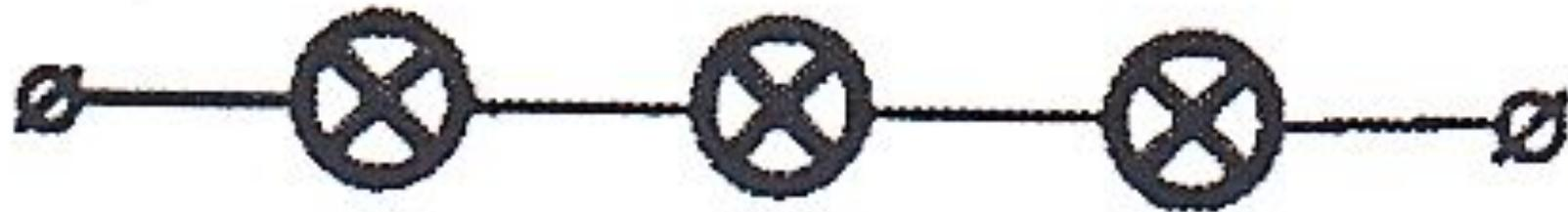
Рис. 5. Последовательное (в смысле надежности) соединение элементов прибора
