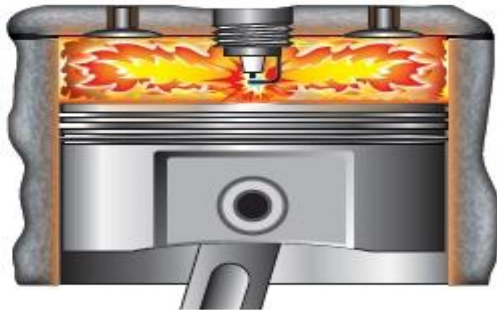
При нормальном процессе сгорания воспламенение свежих порций рабочей смеси и перемешивание фронта пламени по камере сгорания происходит вследствие передачи тепла под действием теплопроводности и лучеиспускания
