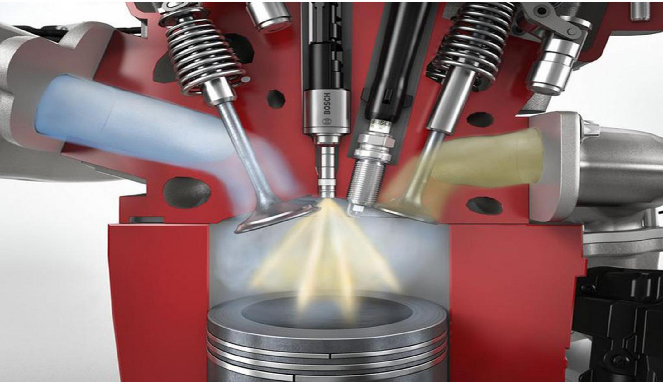
В жидком топливе имеют место легкие, средние и тяжелые молекулы. В процессе распыливания топлива легкие фракции уже являются газифицированными и в окружении кислорода воздуха под действием температуры электрической искры (10000 0С) воспламеняются, образуя начальную зону пламени (бензиновые двигатели)
