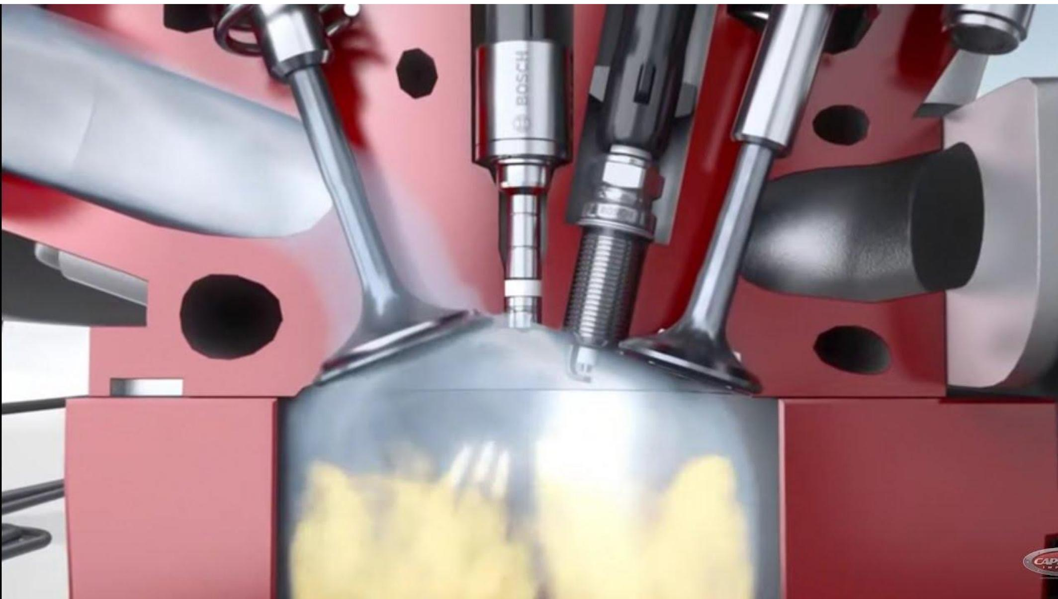
Перекиси накапливаются в несгоревшей части рабочей смеси и при достижении критической концентрации распадаются со взрывом и выделением большого количества тепла, активизируя всю рабочую смесь
