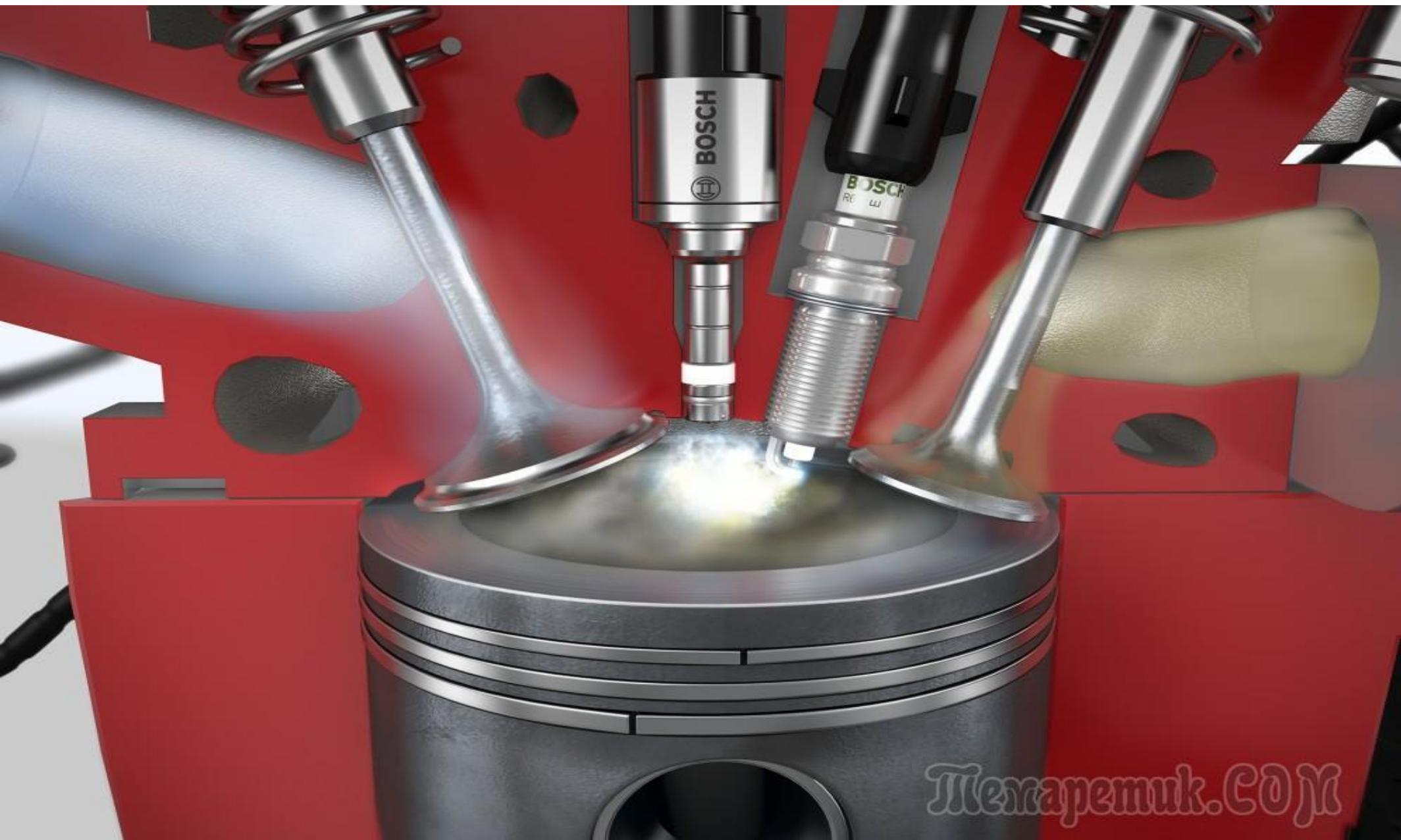
**Окисление** – реакция взаимодействия молекул углеводородного топлива с молекулами кислорода. Если температура воздуха достигает требуемого значения, то окисление переходит в процесс горения
