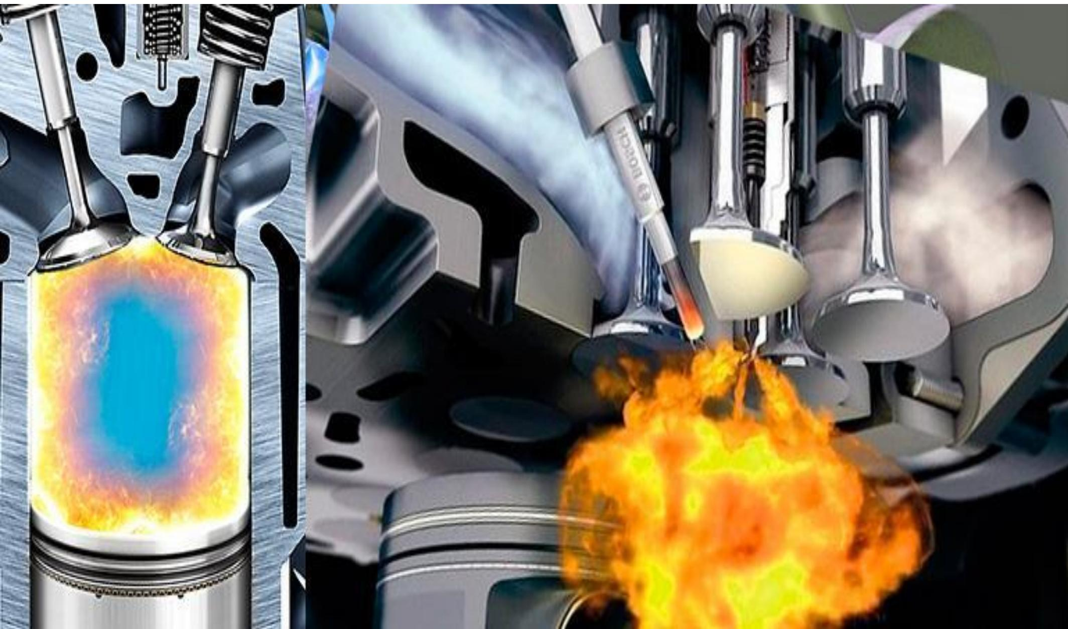
В современных автомобилях в блоке цилиндров установлен датчик детонации. При появлении детонации сигнал с датчика передается на бортовой компьютер, который при помощи исполнительного механизма уменьшает угол опережения зажигания и снижает детонацию
