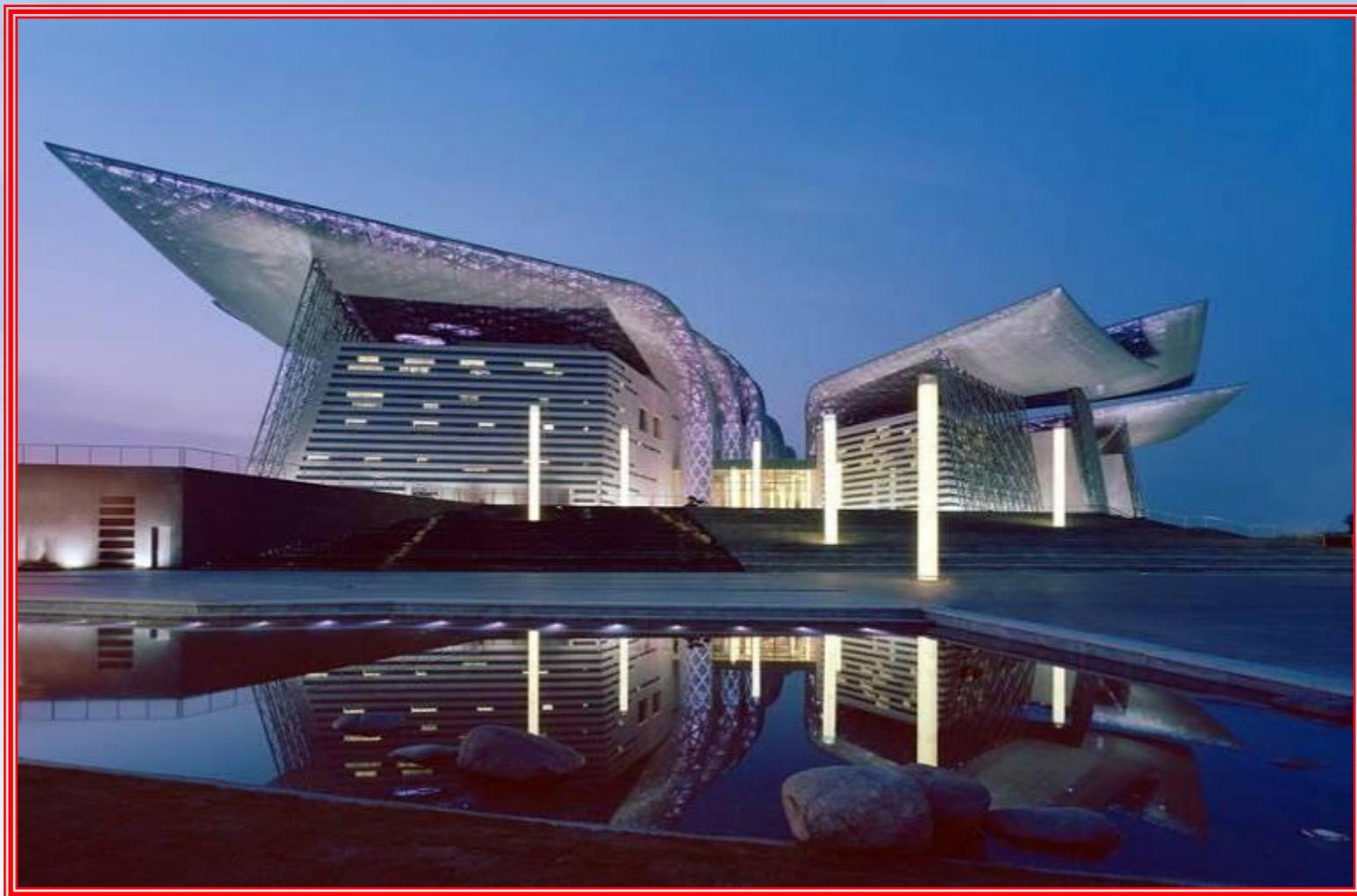
**Восемь гигантских вылетов крыши, далеко выходящих за пределы фасадов здания, делают уместным сравнение театра с бабочкой. Одной из важных функций, которую они взяли на себя, стала защита здания от лишнего солнечного тепла. Внутри стальных крыльев расположены тысячи светодиодов, которые позволяют изменять их цвет.**
