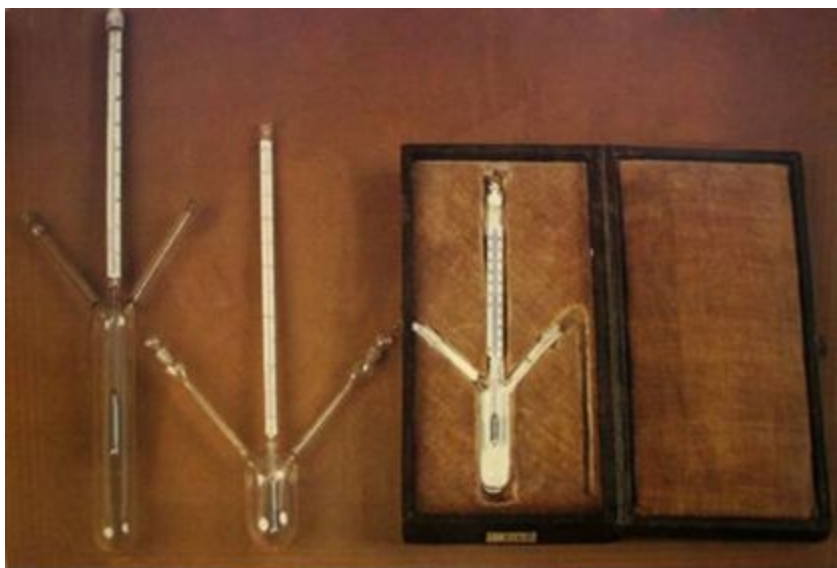
Пикнометр конструкции Д.И. Менделеева
