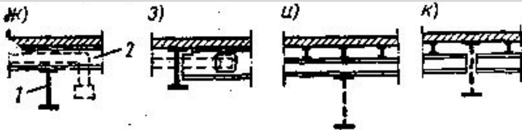
Рис. 6.6. Компоновка ячеек балочных перекрытий
