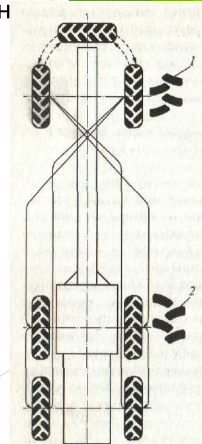
*При ТР ходовой части колесных машин (с зависимой подвеской)*
