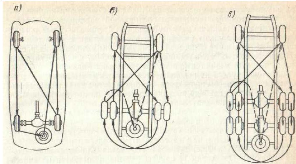
Передние и задние шины СДМ (автогрейдеров, погрузчиков, скреперов) изнашиваются неравномерно, поэтому при их смене необходимо обращать внимание на расположение рисунка протектора ведущих и ведомых колес.
