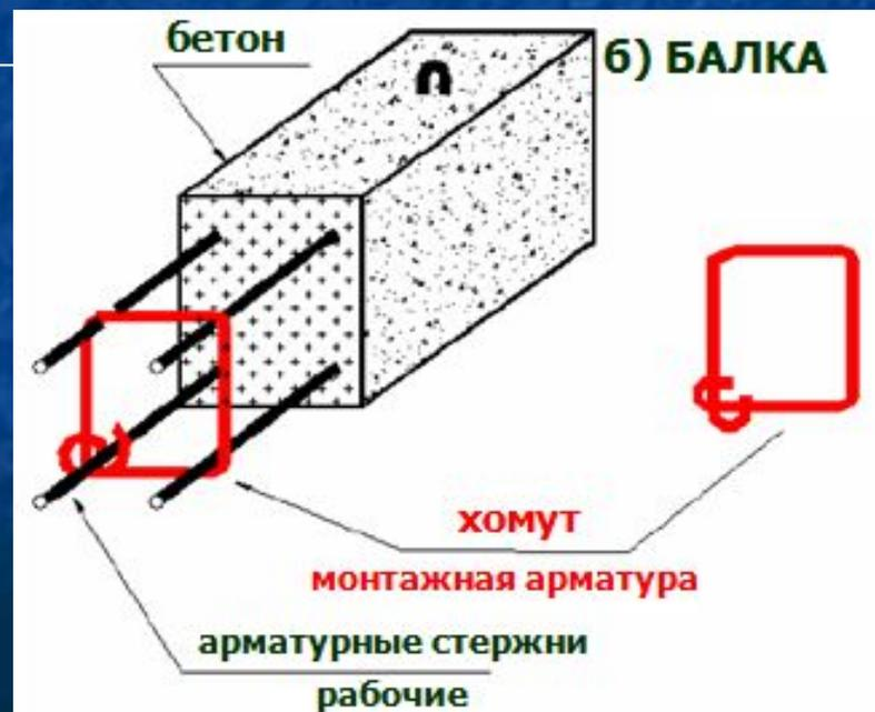
Виды арматуры в сборных конструкциях: а) плита; б) балка
