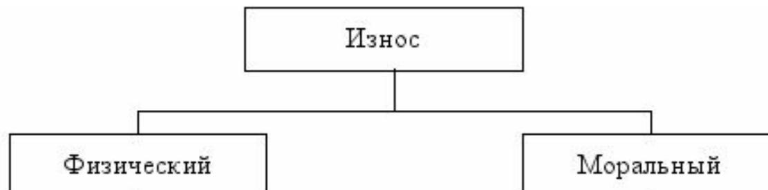
**Физический износ** выражается в потере основными фондами технических свойств и характеристик в результате эксплуатации, атмосферных воздействий, условий хранения.
