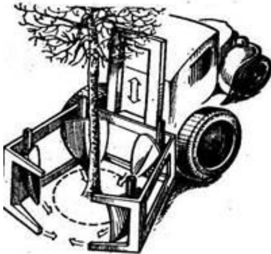
Выкопка дерева с комом с помощью гидравлической машины
