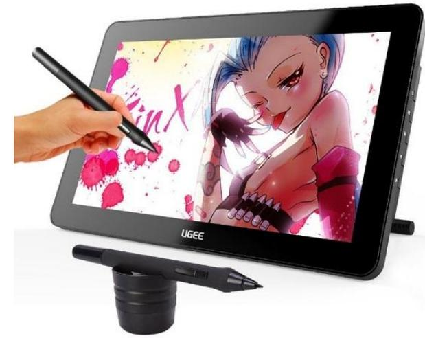
**Графический планшет** (от англ. *graphics tablet* или *graphics pad*, *drawing tablet*, *digitizing tablet*, *digitizer* — *дигитайзер*, *диджитайзер*) — это устройство для ввода информации, созданной от руки непосредственно в компьютер. Состоит из пера и плоского планшета, чувствительного к нажатию или близости пера. Также может прилагаться специальная мышь
