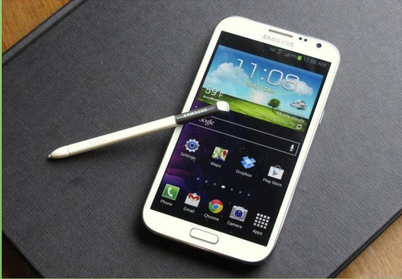
**Фаблет** (англ. *phablet* от *phone* телефон и *tablet* планшет) — смартфон, имеющий сенсорный экран, размер которого находится между размером типичного смартфона и планшетного компьютера: с диагональю от 5,5 до 6,9 дюймов и шириной не более 135 мм. Совмещает функции с свойствами смартфона и интернет-планшета.
