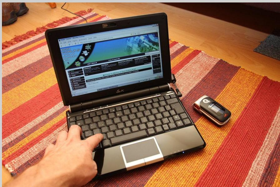
Обладает небольшой диагональю экрана в 7—12 дюймов, низким энергопотреблением, небольшим весом и относительно невысокой стоимостью.
