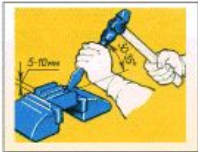
Срубание слоя металла на широкой плоской поверхности
