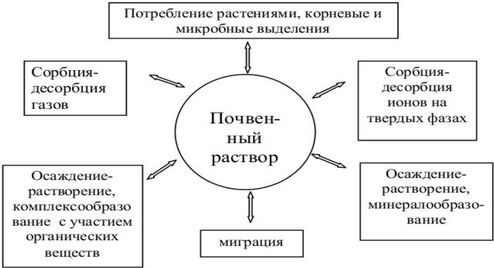
Рис. 1. Почвенный раствор как компонент открытой многофазной системы
