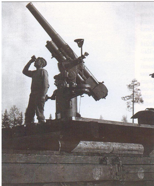
76-мм зенитная пушка Ф. Ф. Лендера обр. 1914/15 г. Калибр, мм: 76,2 Дальность стрельбы, км: 8,3 Скорострельность, выстр./мин: 10-12
