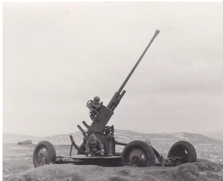
37-мм автоматическая зенитная пушка обр. 1939 г. Калибр, мм: 37 Дальность стрельбы, км: 1,1 Скорострельность, выстр./мин: 160-170
