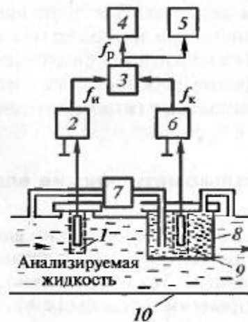
Рис. 8.7. Диэлькометрический поточный влагомер нефти:
