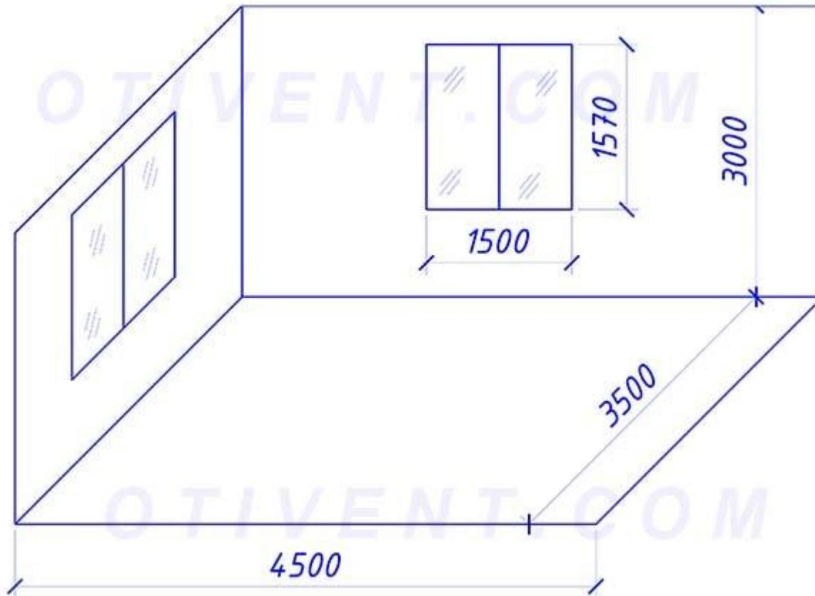
Суть расчета тепловых потерь относительно проста: нужно выяснить, сколько энергии теряет каждая конструкция, ведь окна, стенки и полы сделаны из разных материалов. Определяя квадратуру наружных стен, вычитайте площадь остекленных проемов — последние пропускают больший тепловой поток и потому считаются отдельно.
