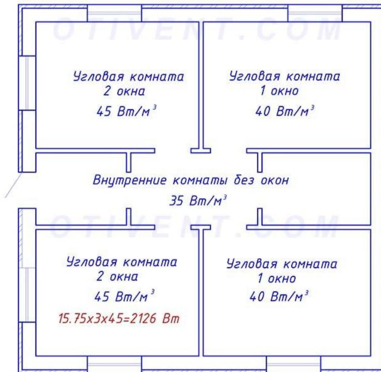
Заметно, что требуемая тепловая мощность системы отопления выросла на 200 Вт по сравнению с предыдущим расчетом. Если же принять высоту комнат 2.7—2.8 м и сосчитать затраты энергии через кубатуру, то цифры получатся примерно одинаковые. То есть, способ вполне применим для укрупненного подсчета теплопотерь в помещениях любой высоты.
