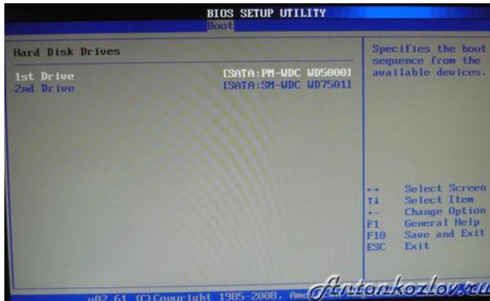
**Конфигурация жестких дисков на ведущего и ведомого при помощи BIOS и раздела Hard Disk Drives**
