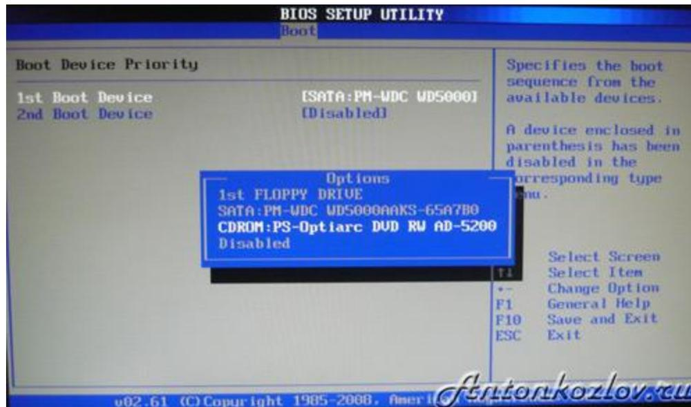
**Для того, чтобы установить операционную систему нужно первым поставить привод лазерных дисков**
