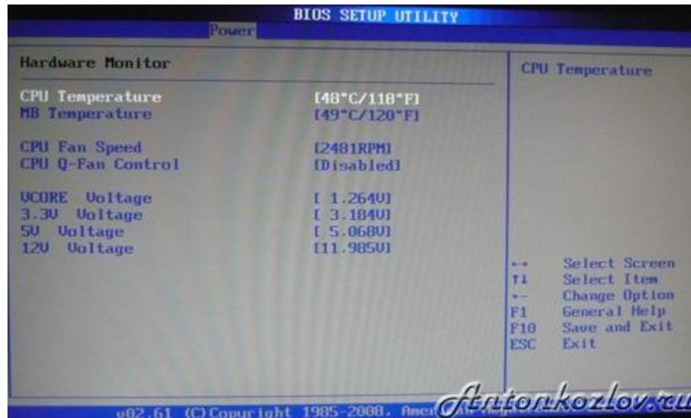
**Данные температуры и вольтажа в разделе BIOS Hardware Monitor**
